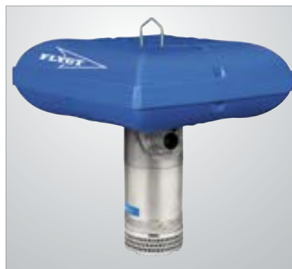
Flygt-pumppulautta*. Mahdollistaa pumpun sopeutumisen muuttuviin vesipintoihin.
