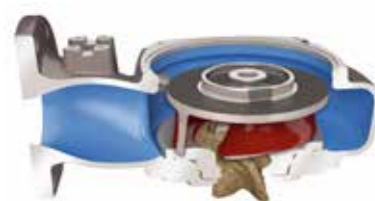
1: N-pumpun puoliavoin juoksupyörä ja siirtoura toimivat yhdessä. N-juoksupyörän siivet, joissa on taaksepäin kaartuvat johtoreunat, pyyhkivät kiintoaineet keskeltä tuloaukon kehälle.
