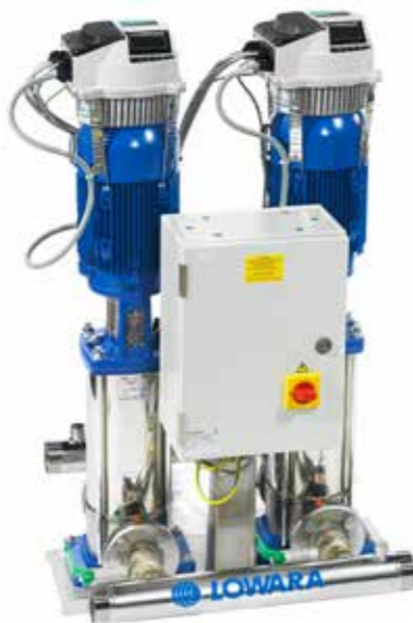
Lowara GHV-paineenkorotusasema rinnan kytketyillä e-SV-pumpeilla, täydellisenä putkistoineen, ohjauskaappeineen ja varustettuna Hydrovar-taajuusmuuttajalla, joka parantaa luotettavuutta ja pidentää käyttöikä. Sarjaan kytketyt pumput antavat lisäkapasiteettia, kun virtaama on suurimmillaan - ja jos yksi pumpeista on poistettava käytöstä, muut pumput pystyvät korvaamaan sen.
