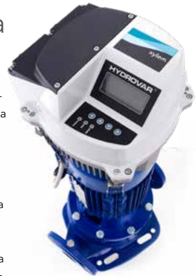
Lowara e-SV ja e-LNE-pumput voidaan varustaa Hydrovar-taajuusmuuttajalla siten, että lähtöpaine pysyy vakiona. Nopeudensäädön älykkyyks tekee muista ohjaimista tarpeettomia.
