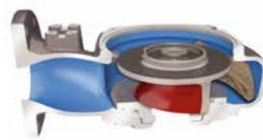
2: Siirtoura ja virtauksenohjain työntävät kiintoaineet, kuten rievut, pois juoksupyörästä.
